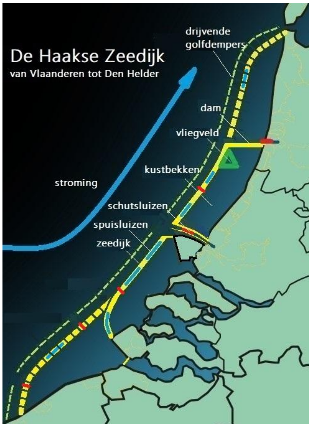
Figuur 25: Schematische weergave van een variant van De Haakse Zeedijk. Samenwerken met de ondiepe en zandige bodem van de Noordzee en de zandaanvoerende stromingen vormt de basis van deze nieuwe kustlijn. Adviesgroep Van den Haak & Butijn
