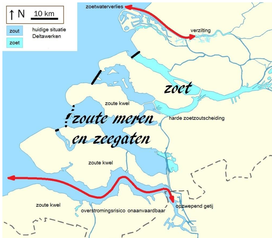
Figuur 10: Het oorspronkelijke Deltaplan beoogde kustlijnverkorting door afsluiting van de zeegaten (zie figuur 5, pagina 15). De hiervan afwijkende Deltawerken brachten zoute meren en (half)open zeegaten met onaanvaardbare risico's voor waterveiligheid en zoetwatervoorziening. Adviesgroep Borm & Huijgens
