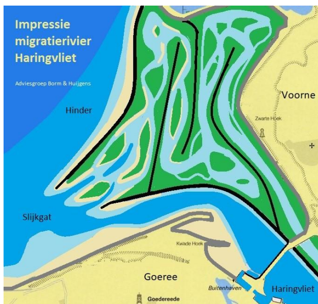
Figuur 19: Een impressie van een migratierivier op de ondiepe vlakte van de Hindersplaat en de Slikken van Voorne met een ruim 40 km lange stroomroute in een continue open verbinding met zee en rivieren..
