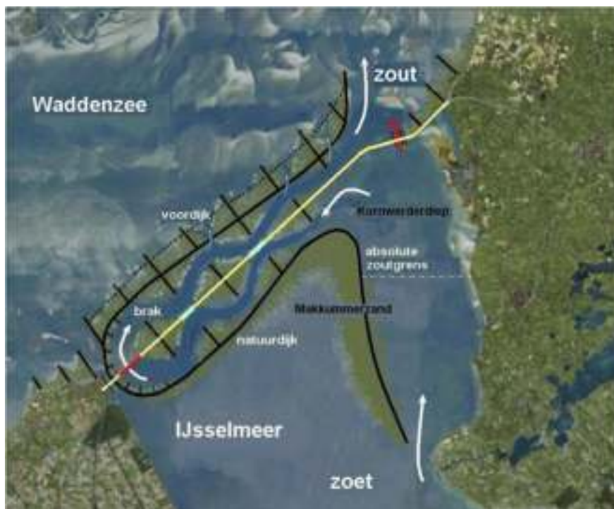
Figuur 3.9 Afsluitdijk met aan de waddenzijde een dijk met aangroeien- de klimaatbuffer en aan de zuidzijde een natuur- dijk. Beide beschermen tegen golfslag en kruisend ijs. Een lange geïntegreerde migratie- rivier zorgt tevens voor afvang van zoute indringing en overslag. Zo blijft het IJsselmeer zoet en is er een ecologische overgang van zout naar zoet.
